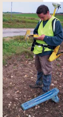
Des mesures précises sur le terrain avec le RD4000 de Radiodétection et le GPS Pro XRS de Trimble.
