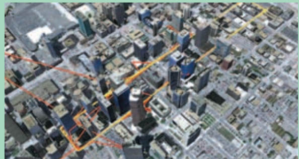
Trace rouge produite par un GeoExplorer 2008 (ou série 3000), trace jaune produite par un GeoExplorer série 6000 avec technologie Floodlight activée.
