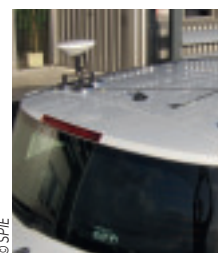
Les antennes GPS et la cellule photoélectrique s'installent facilement sur un véhicule
