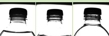
Contrôle du niveau de remplissage
