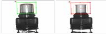
Contrôle du bouchon pour assurer la qualité hygiénique des bouteilles à boissons
