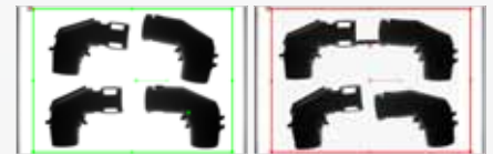
Contrôle de la séparation de pièces moulées en plastique
