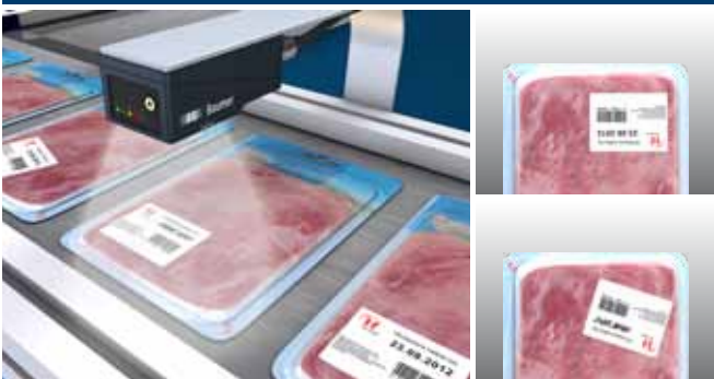
VeriSens® XF-100/XF-200 Inspection de qualité et identification
