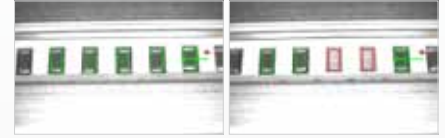
Contrôle de composants SMD d'automates de garnissage (Tape & Reel)
