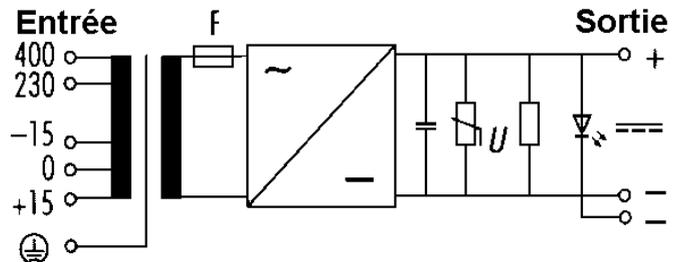
Jusqu'au modèle 7,5 Ampères, un fusible plat est installé pour protéger la sortie de l'alimentation :
